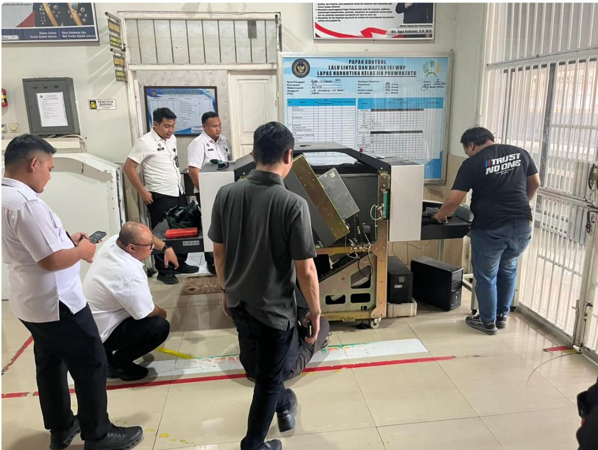
Adapun rangkaian kegiatan pemeriksaan yang telah dilaksanakan pada Kamis (5/2) meliputi pengecekan body mesin yang mengalami kebocoran listrik, perbaikan perangkat PC, serta perbaikan hard disk drive (HDD) yang tidak terdeteksi oleh sistem. Selanjutnya, pada Jumat (6/2), kegiatan difokuskan pada pemasangan kabel grounding, penggantian baterai CMOS, serta pengaturan ulang (set) password BIOS guna mendukung kinerja sistem X-Ray secara maksimal.
